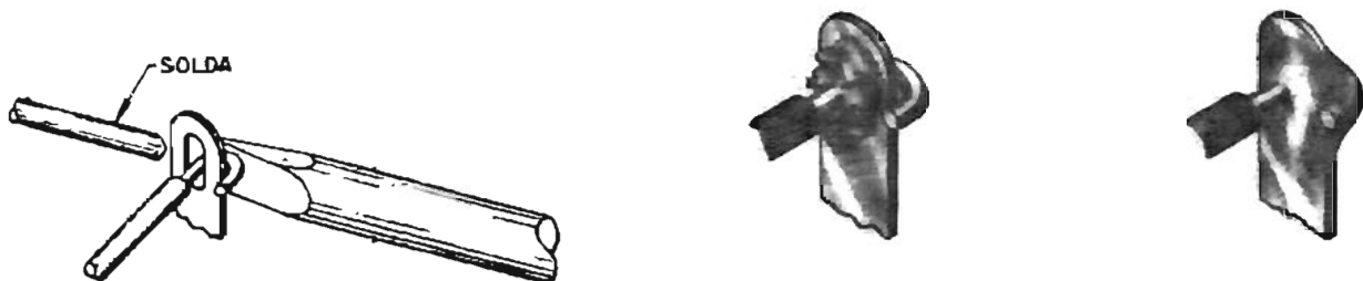
Figura 4 - Detalhes da ligação e soldagem a terminais
